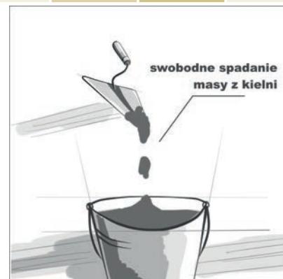
Rozpoznawanie gotowości tynku do użytku
