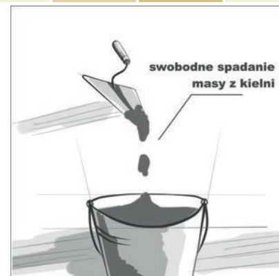
Rozpoznawanie gotowości tynku do użytku
